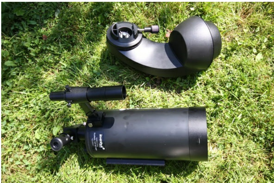
Сборка телескопа состоит из двух простейших операций. Сначала установите вилку на треногу и приверните ее винтом к основанию. Затем поставьте трубу на вилку.
