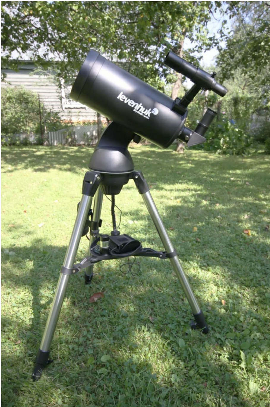
Сборка телескопа состоит из двух простейших операций. Сначала установите вилку на треногу и приверните ее винтом к основанию. Затем поставьте трубу на вилку.
